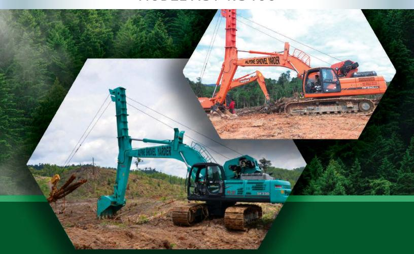
DOUBLE DRUM HYDRAULIC INTERLOCK IS CAPABLE OF OPERATION WITHOUT THE NEED OF GUY LINES. THESE VERSATILE YARDERS CAN YARD UPHILL AND DOWNHILL. THIS HIGHLY MOBILE YARDING SYSTEM MEETS
